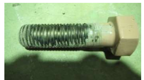
厚い塗装したボルト剥離
